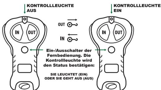
Hinweis: die Batterie befindet sich hinten; wenn die Fernbedienung nicht genutzt wird, sollte man sie ausschalten (die Kontrollleuchte ist aus), die Fernbedienung ist an einem trockenen Ort aufzubewahren.
